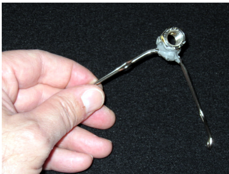
La tuerca y el clip se han unido con el pegamento. Hay que cuidar que la unión no sea totalmente perpendicular sino con una pequeña inclinación para que al colocar el
