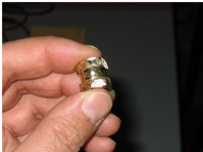
Detalle de la tuerca una vez limada.
